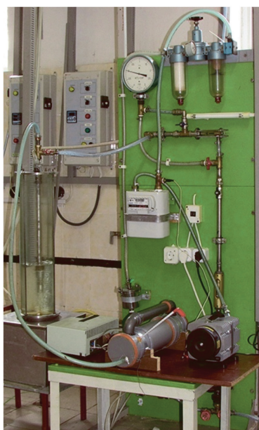
Рис. 1.9.6. Експериментальний стенд: а – зовнішній вигляд; б – кавітаційна течія на робочій ділянці кавітатора; в – іонізація газу у бар'єрному розряді на розрядниках генератора озону; г – осцилограма генерації бар'єрного розряду U_A = 8,4 \text{ кВ} , 1 \text{ кГц}
