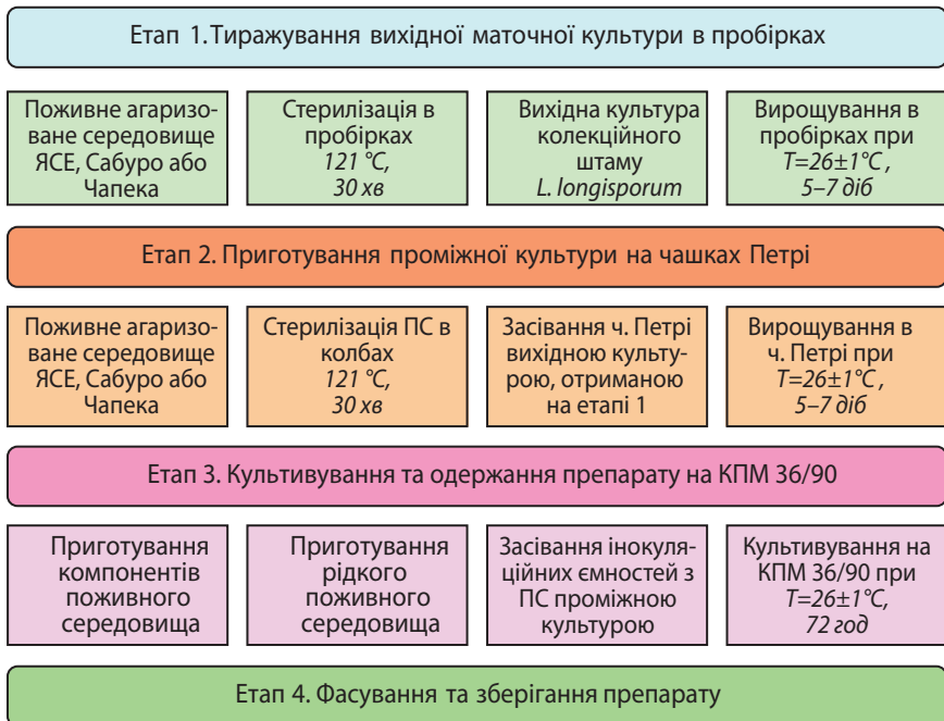
Рис. 2.8.2. Технологія виробництва Ліканіциліну БТ на основі L. longisporum
