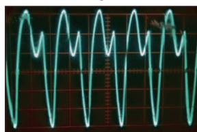
Рис. 1.9.6. Експериментальний стенд: а – зовнішній вигляд; б – кавітаційна течія на робочій ділянці кавітатора; в – іонізація газу у бар'єрному розряді на розрядниках генератора озону; г – осцилограма генерації бар'єрного розряду U_A = 8,4 \text{ кВ} , 1 \text{ кГц}
