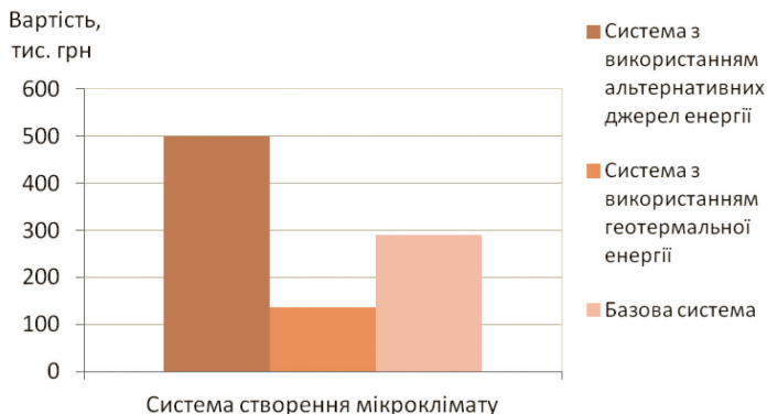
Рис. 1.3.4. Економічне порівняння систем підготовки повітря для технологічних приміщень вирощування комах
